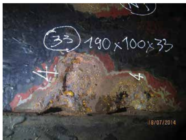
Hình 4. Hiện trạng ăn mòn bên trong tại các hộp nước của thiết bị bình ngưng trong Nhà máy Điện Cà Mau
