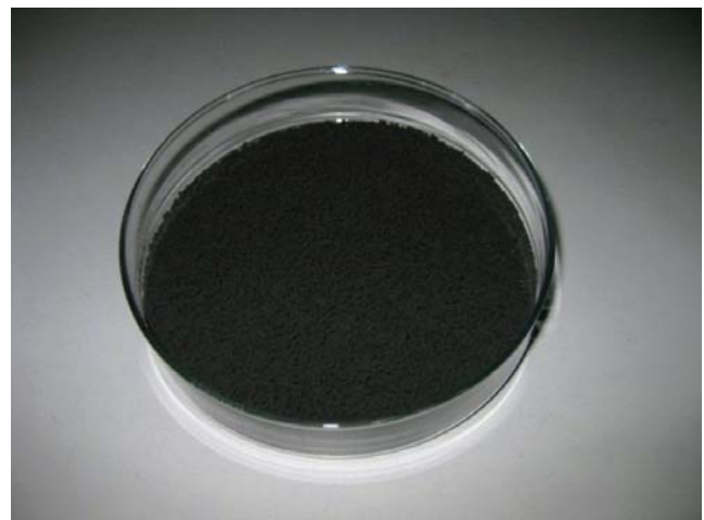
Hình 1. Mẫu xúc tác thải CoMo/γ-Al 2 O 3 từ Phân xưởng Naphtha Hydrotreating của Nhà máy Lọc dầu Dung Quất
