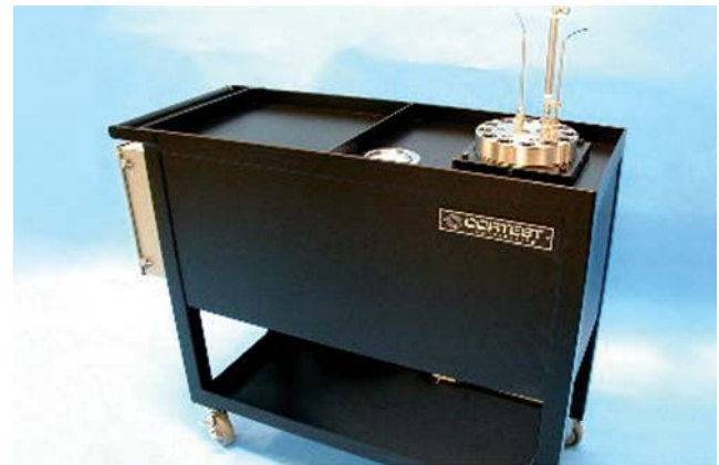
Hình 2. Hệ thiết bị Autoclave thử nghiệm ăn mòn trong điều kiện áp cao nhiệt cao
