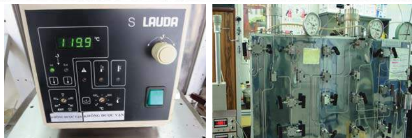
Hình 5. Mô hình và thiết bị đánh giá sự thay đổi độ thấm của mẫu lõi
