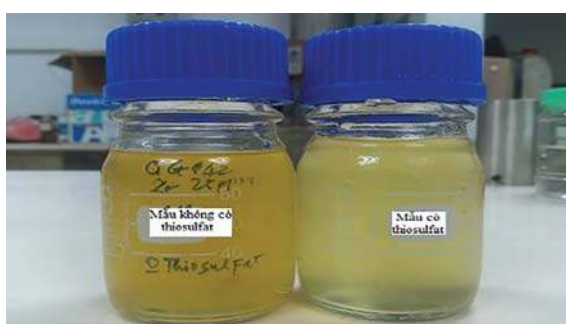
Hình 6. Ảnh hưởng của Na 2 S 2 O 3 .5H 2 O đến khả năng chịu nhiệt của hệ gel polymer
