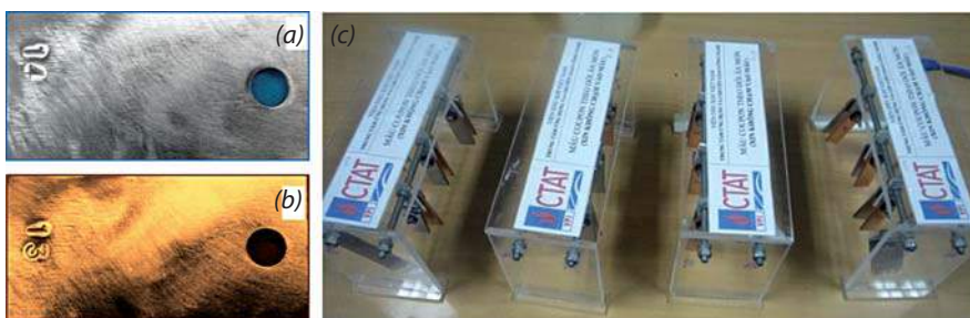
Hình 1. Mẫu coupon thép (a), mẫu coupon đồng (b) và giá mẫu coupon (c)
