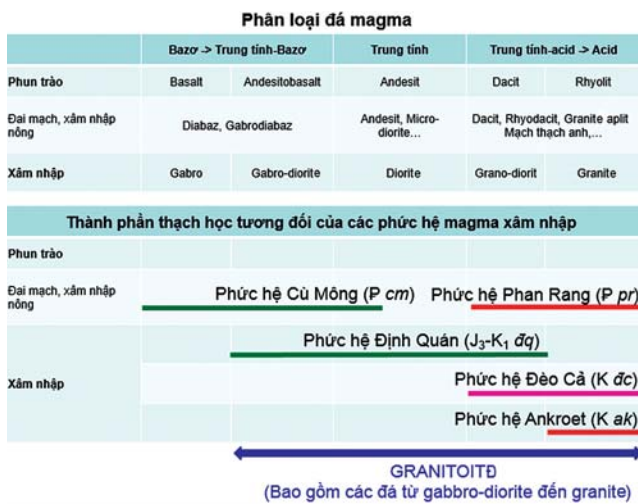
Hình 2. Phân loại các loại đá móng theo đặc tính và thành phần khoáng vật
