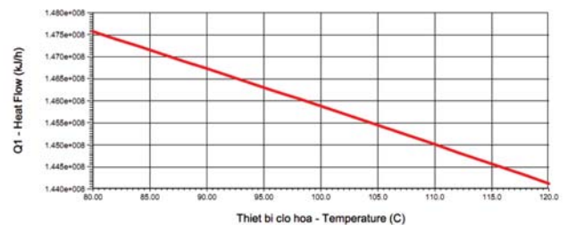
Hình 3. Ảnh hưởng của nhiệt độ tới độ chuyển hóa phản ứng clo hóa và nhiệt lượng cần tách
